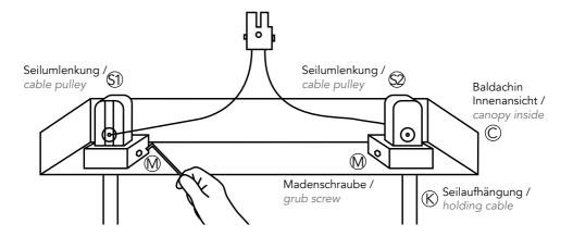
Aufgrund der Natürlichkeit des Materials Holz und seiner eigenen Holzdichte variiert das Eigengewicht eines jeden HerzBlut-Leuchtenkörpers ①. Die Gegengewichte (F) sind auf ein Durchschnittsgewicht abgestimmt. Wenn der Leuchtenkörper ① schwerer als sein Gegengewicht ist, muss die "zusätzliche Last" aufgefangen werden.
